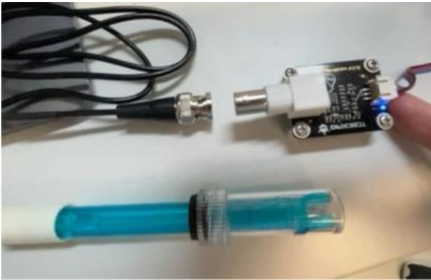
**步驟 1：** 把圓形狀的 BNC 端口對準位置插到 pH meter 电路板的圓形端口，然後把 BNC 插頭向內扭。
