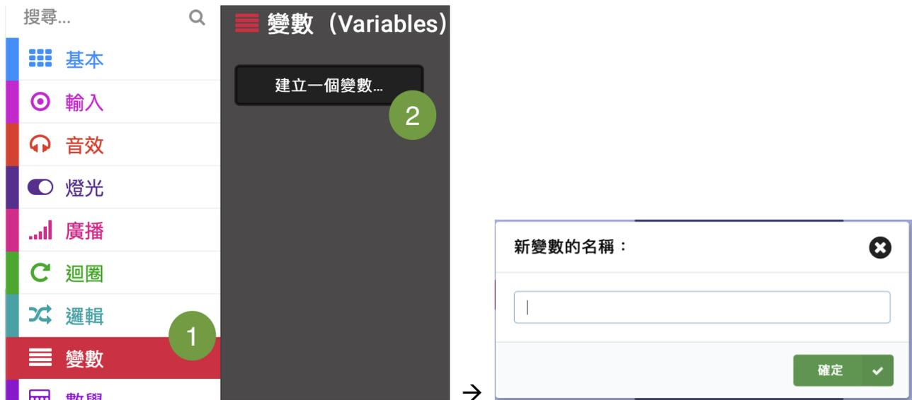
有了 temperature 這個容器，現在便可把溫度感應器偵測所得的數值放進 temperature 中。
